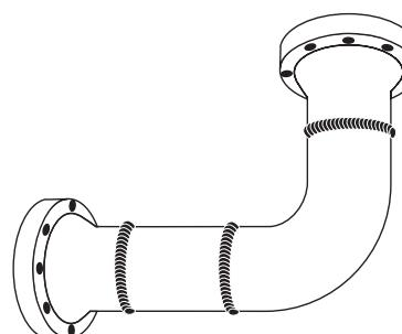
Сварка элементов поверхностей нагрева котлоагрегатов, а также корневых слоев швов стыков толстостенных трубопроводов из углеродистых и низколегированных сталей, работающих при температуре до 400°C. Сварка во всех пространственных положениях шва постоянным током обратной полярности.
